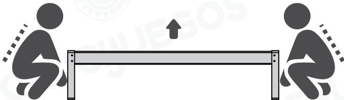
La pieza debe ser adecuadamente izada para que mantenga su estructura y no sea dañada. Para ello se recomienda utilizar eslingas de poliéster que soporten el peso del banco.
