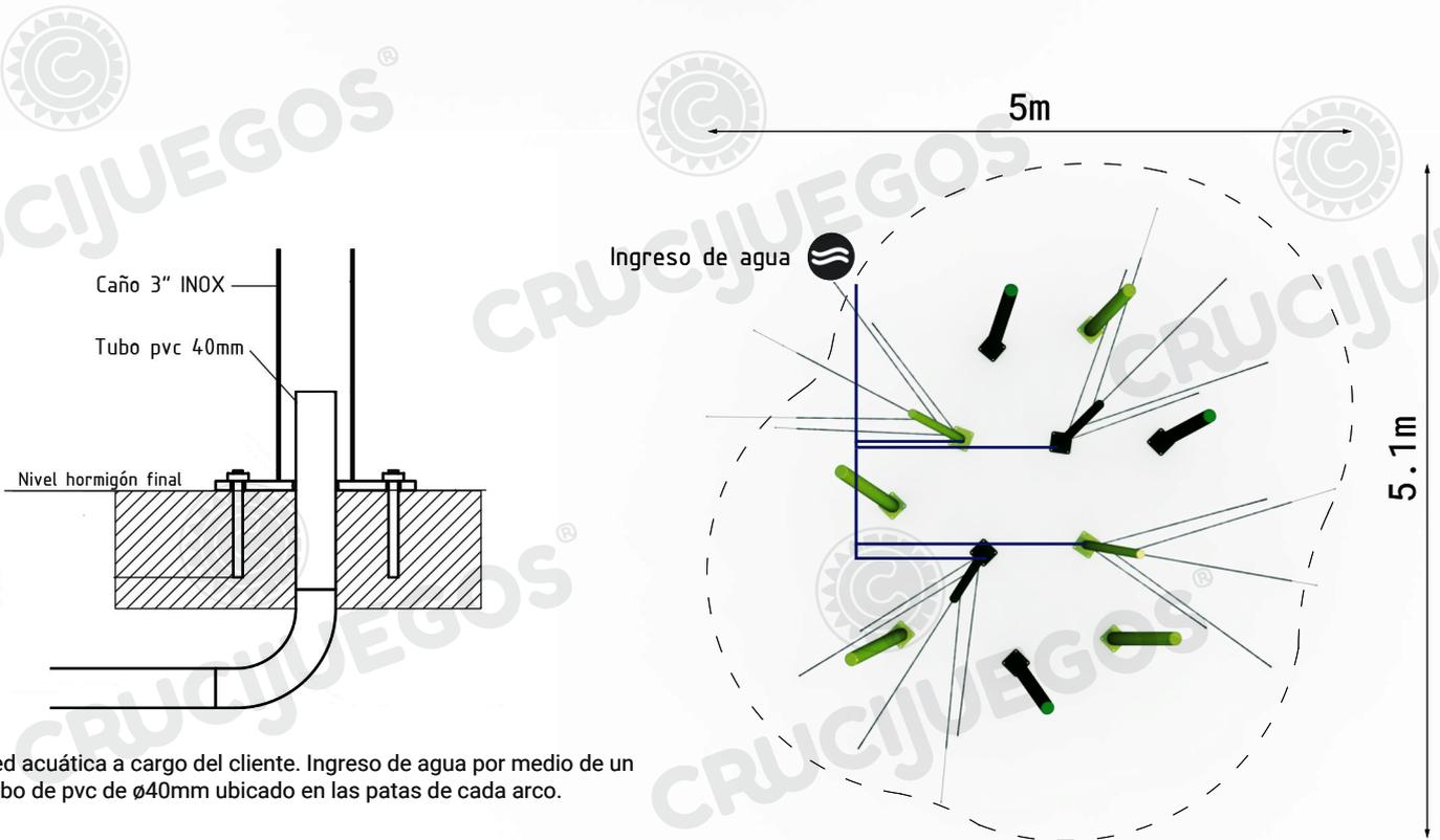
Red acuática a cargo del cliente. Ingreso de agua por medio de un tubo de pvc de  $\varnothing 40\text{mm}$  ubicado en las patas de cada arco.
